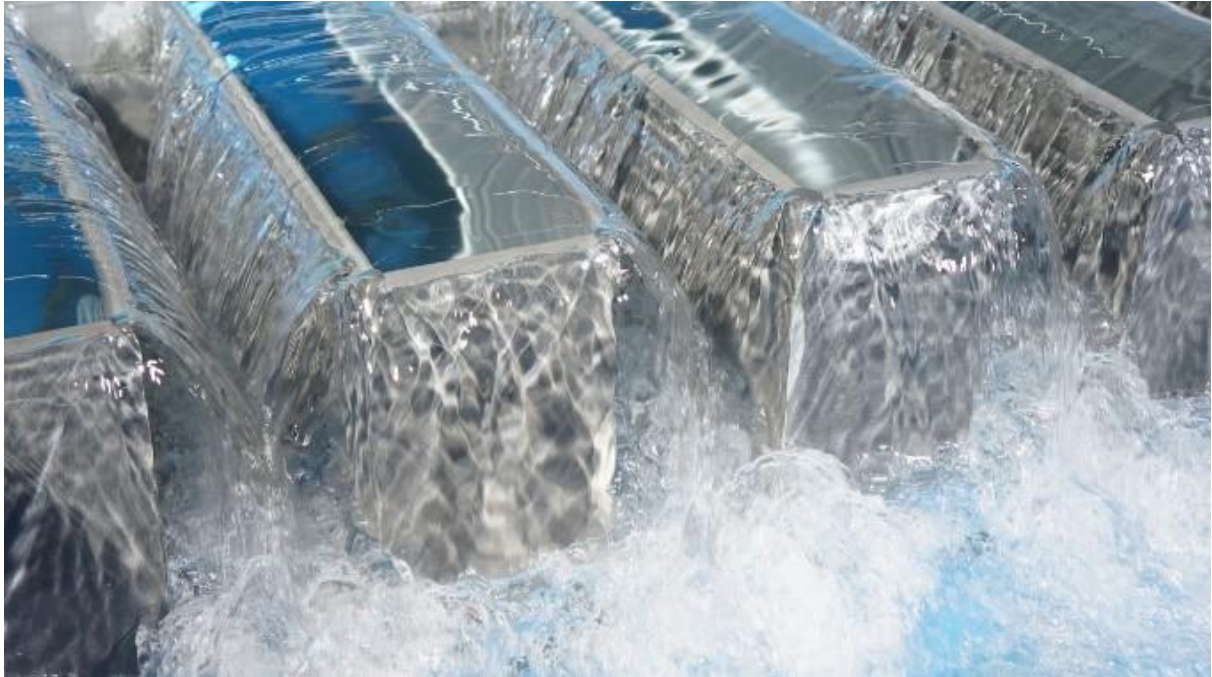
Modell eines Labyrinth-Wehrs in der BAW
